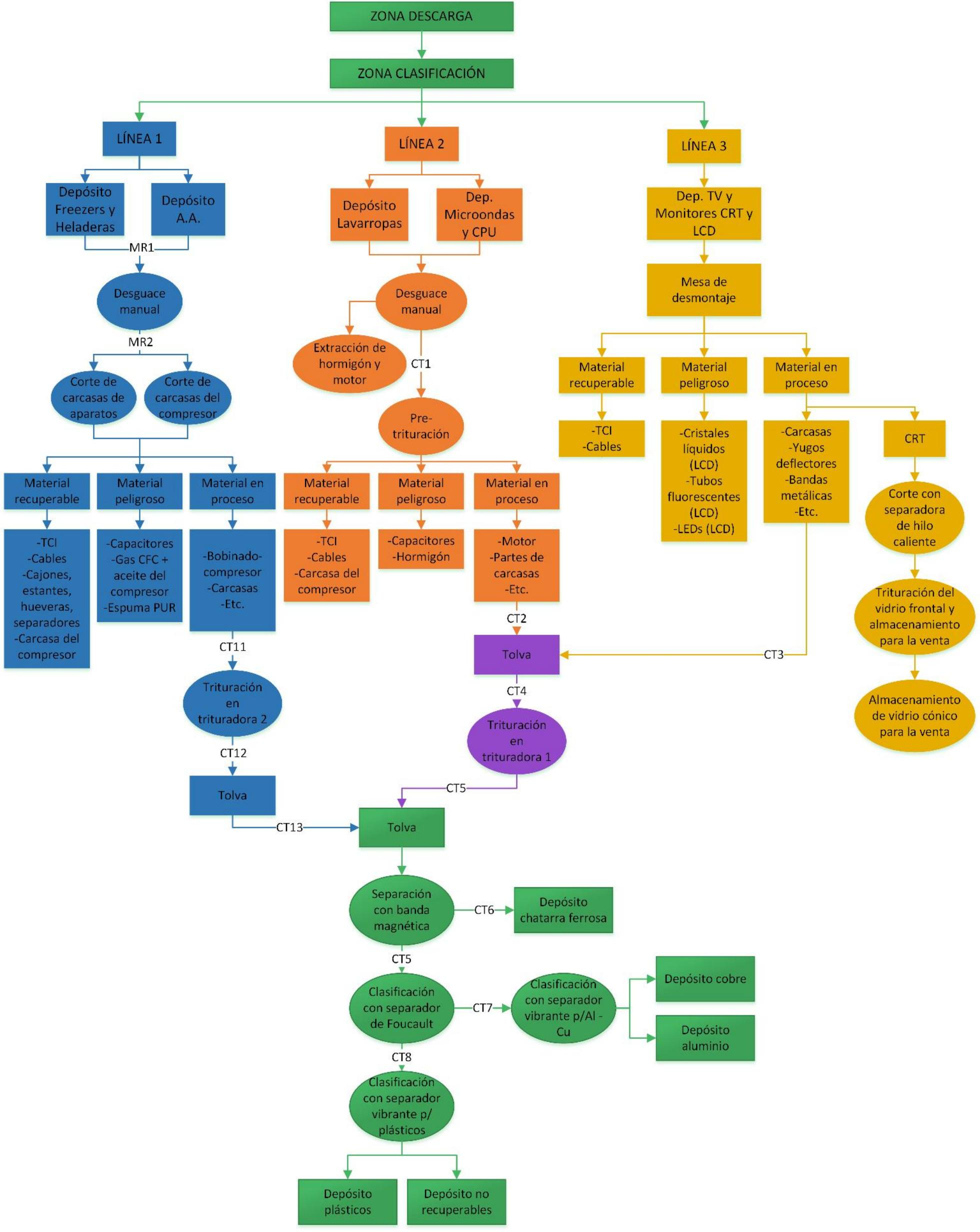
carcasas de aires acondicionados no tienen PUR, por lo que se depositan directamente en la cinta transportadora 11 (CT11) y siguen camino hacia la trituradora 2.
